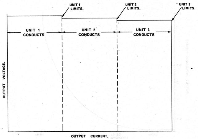
FIGURE 2 - PARALLEL OPERATION.
